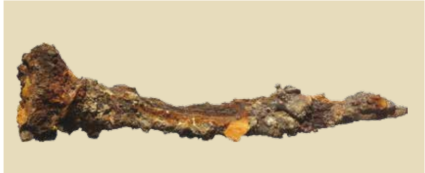
Abb. 1: Konstruktionsnagel vor der Restaurierung, mit ankorrodierten Holzkohleresten von Bauholz (© Univ. Wien/A. Heiss)
