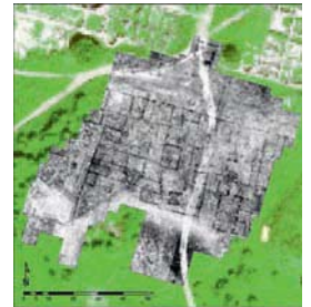
Zur großflächigen Erfassung der Stadt wird Geomagnetik eingesetzt, Details liefert das Bodenradar, das virtuelle Schnitte durch den Untergrund macht. Links: Der Domitianstempel. Unten: Die Verulanushallen.
