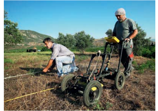
Zur großflächigen Erfassung der Stadt wird Geomagnetik eingesetzt, Details liefert das Bodenradar, das virtuelle Schnitte durch den Untergrund macht. Links: Der Domitianstempel. Unten: Die Verulanushallen.
